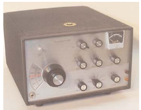
GALAXY V MK II 400 Watt PEP in SSB - 300 Watt in CW Trifft nach einer Anheizzeit 15 Min. weniger als 100 Hz Stroversorgung 800V; 350V; -100V und 12,6 V DC sowie 12,6 V AC
