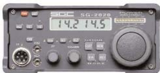
SGC 2020 QRP-Transceiver mit 10W
